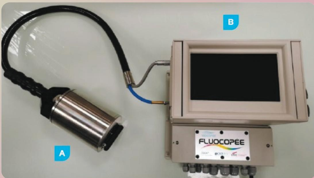
Figure 1.E2.3 : Sonde de fluorescence Fluocopée® avec le capteur immergé (A) le module de surface (B). La longueur de la connexion optique et électrique entre le module de surface et le capteur immergé peut atteindre 15 mètres.
