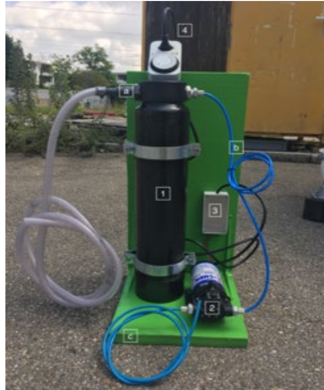
Epurateur Filtre à charbon
